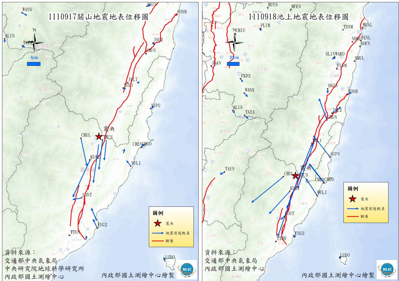
圖 1 111 年 9 月 17 日 (左) 及同年 9 月 18 日 (右) GNSS 連續站位移圖
